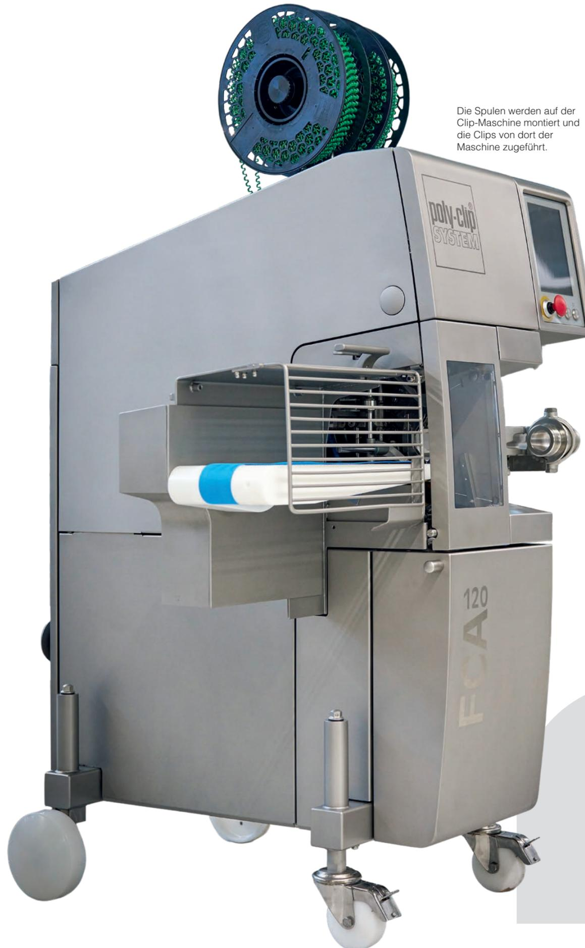
Die Spulen werden auf der Clip-Maschine montiert und die Clips von dort der Maschine zugeführt.
