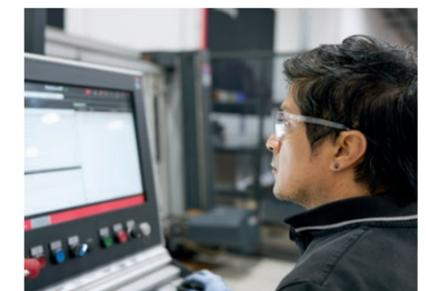
Start einer Bohr- und Fräsbearbeitung mit der Perforex von Rittal.
